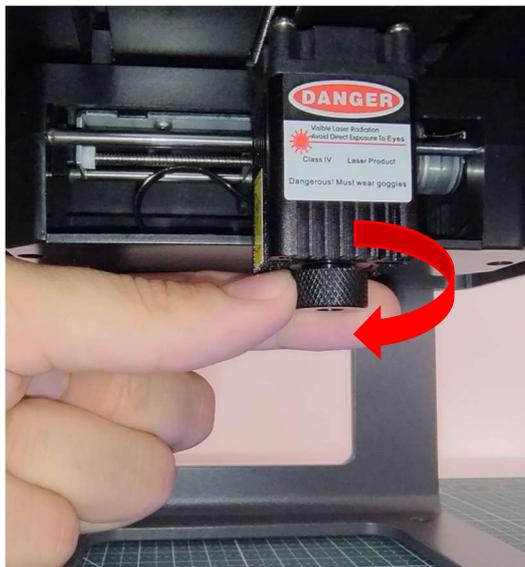
Il laser è messo a fuoco correttamente quando il **punto luminoso risulta il più piccolo possibile.**
